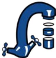
Le mousseur (ou brise-jet) **se place au bout du robinet et diminue la quantité d'eau tout en gardant la pression**.
