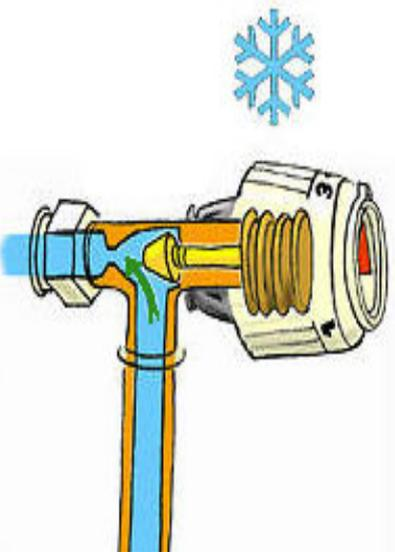
Les vannes thermostatiques **règlent la quantité d'eau chaude qui passe dans chaque radiateur. Elles sont notées de 0** (complètement fermées) **à 5** (complètement ouvertes). En général, entre 3 et 4 elles donnent une température de 20 degrés.
